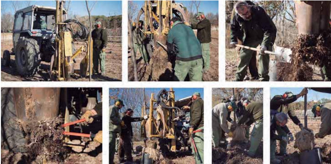
Fig. 11. Proceso de extracción de un árbol con máquina encepellonadora [SI].
